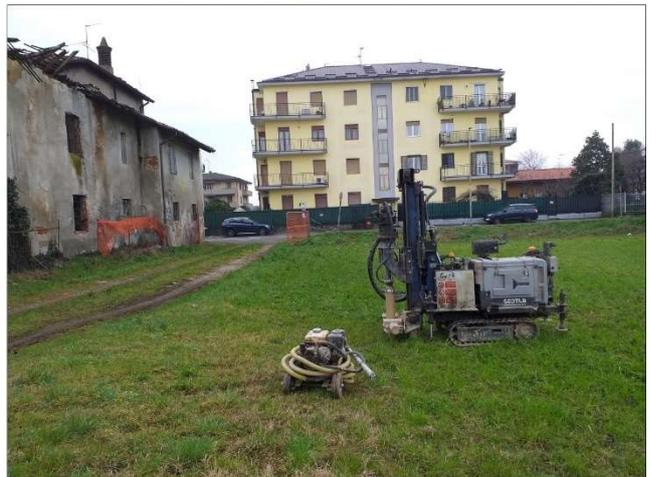
**FIGURA 1** – IN ALTO: UBICAZIONE DEI SONDAGGI A CAROTAGGIO CONTINUO (S01÷04), DELLE INDAGINI SISMICHE MASW (A÷D) E HVSR (1÷10) REALIZZATE A FEBBRAIO-MARZO 2023. IN VIOLA, L'UBICAZIONE DELLE INDAGINI PREGRESSE RELATIVE A PRATICHE EDILIZIE FORNITE DALL'UFFICIO TECNICO DEL COMUNE E ALLE INDAGINI DI CUI AL PRECEDENTE STUDIO COMUNALE DEL 2015. IN BASSO: IMMAGINI RELATIVE ALLA CAMPAGNA DI INDAGINE CONDOTTA PER IL PRESENTE STUDIO.
